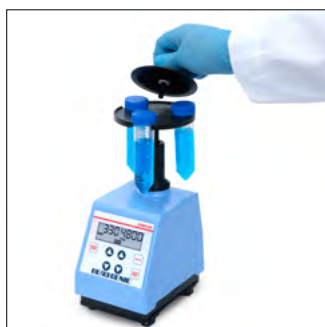
4. Założyć pokrywę i dokręcić śrubę motylkową
